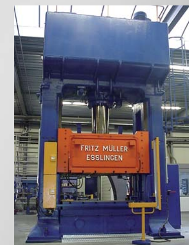
Geautomatiseerde productielijn met 250 ton dieptrekpers
